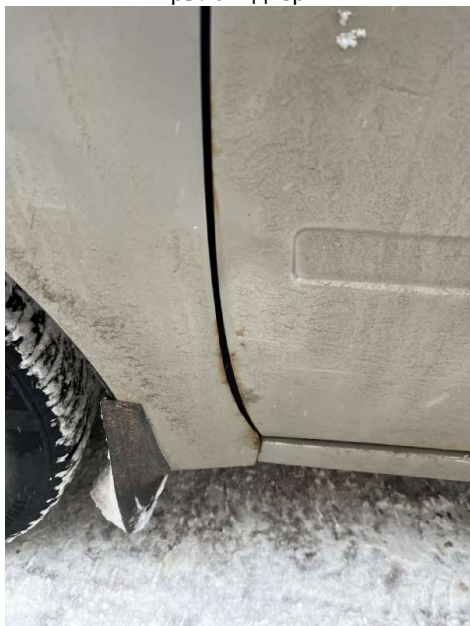
Левое переднее крыло, следы коррозии и повреждений лакокрасочного покрытия по кромке крыла и двери
